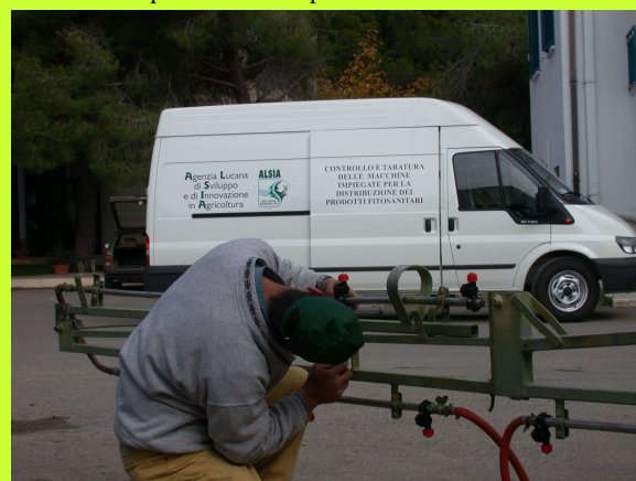
Figura 2. Operazione di taratura degli atomizzatori. Le macchine ben funzionanti consentono di risparmiare fitofarmaci.
