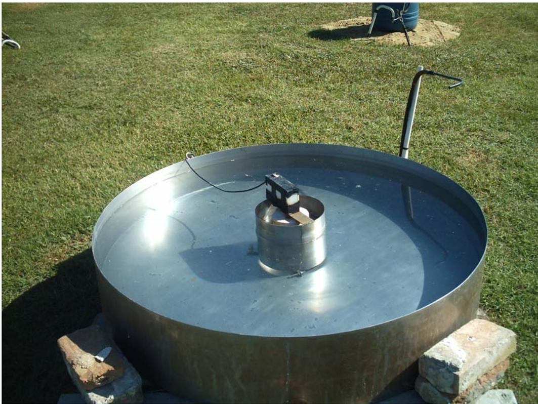
Figura 2. Vasca evaporimetrica di classe "A".
