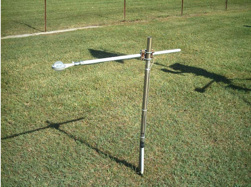
Figura 3. Net-radiometro
