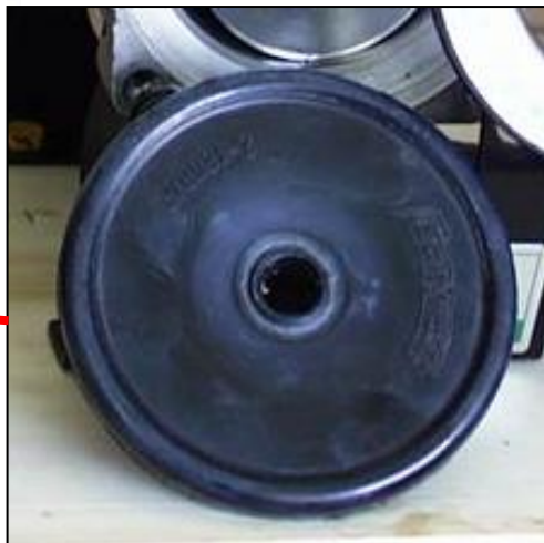
Membrana in polimeri speciali (Viton)
