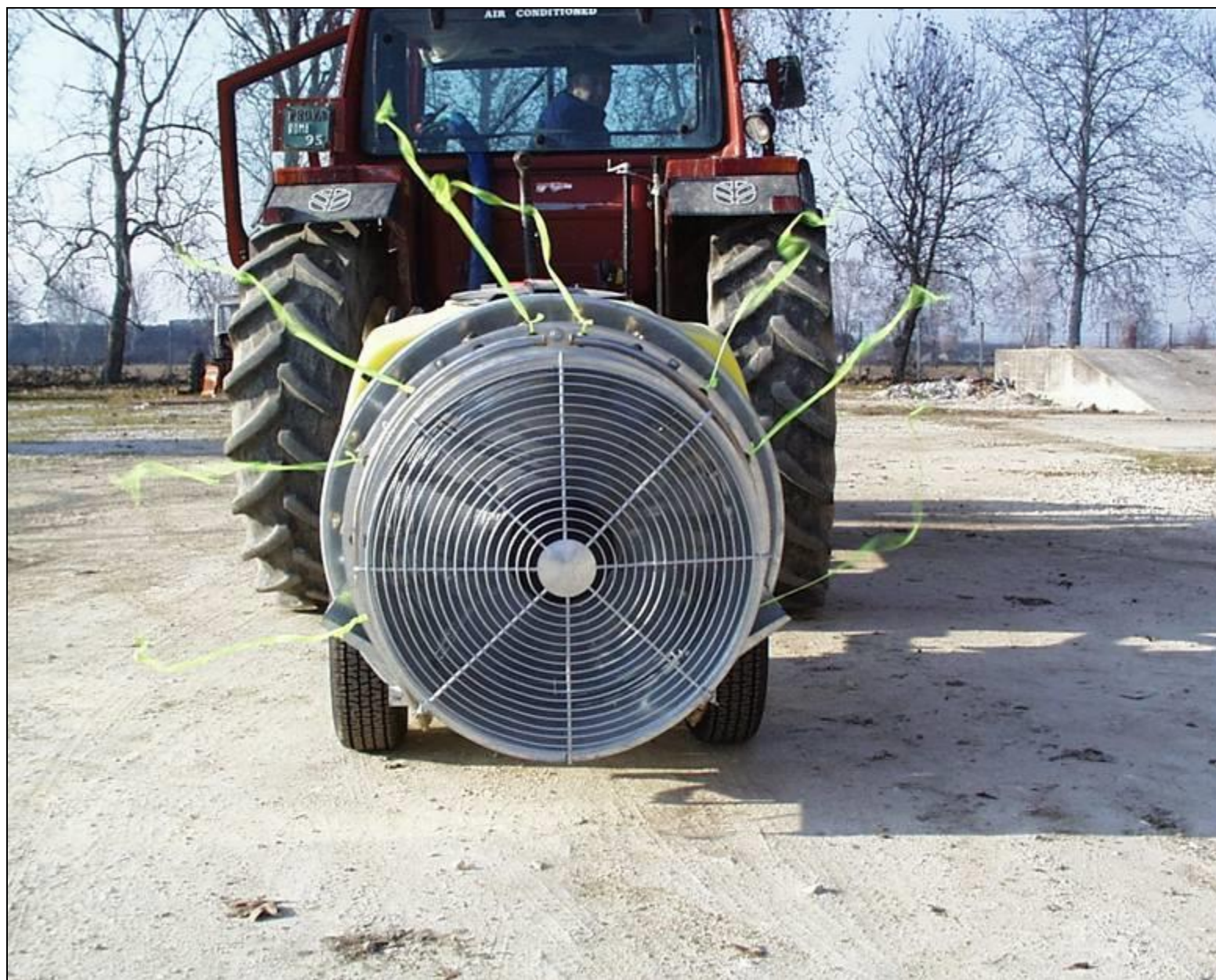
Direzione flusso d'aria di una ventola assiale
