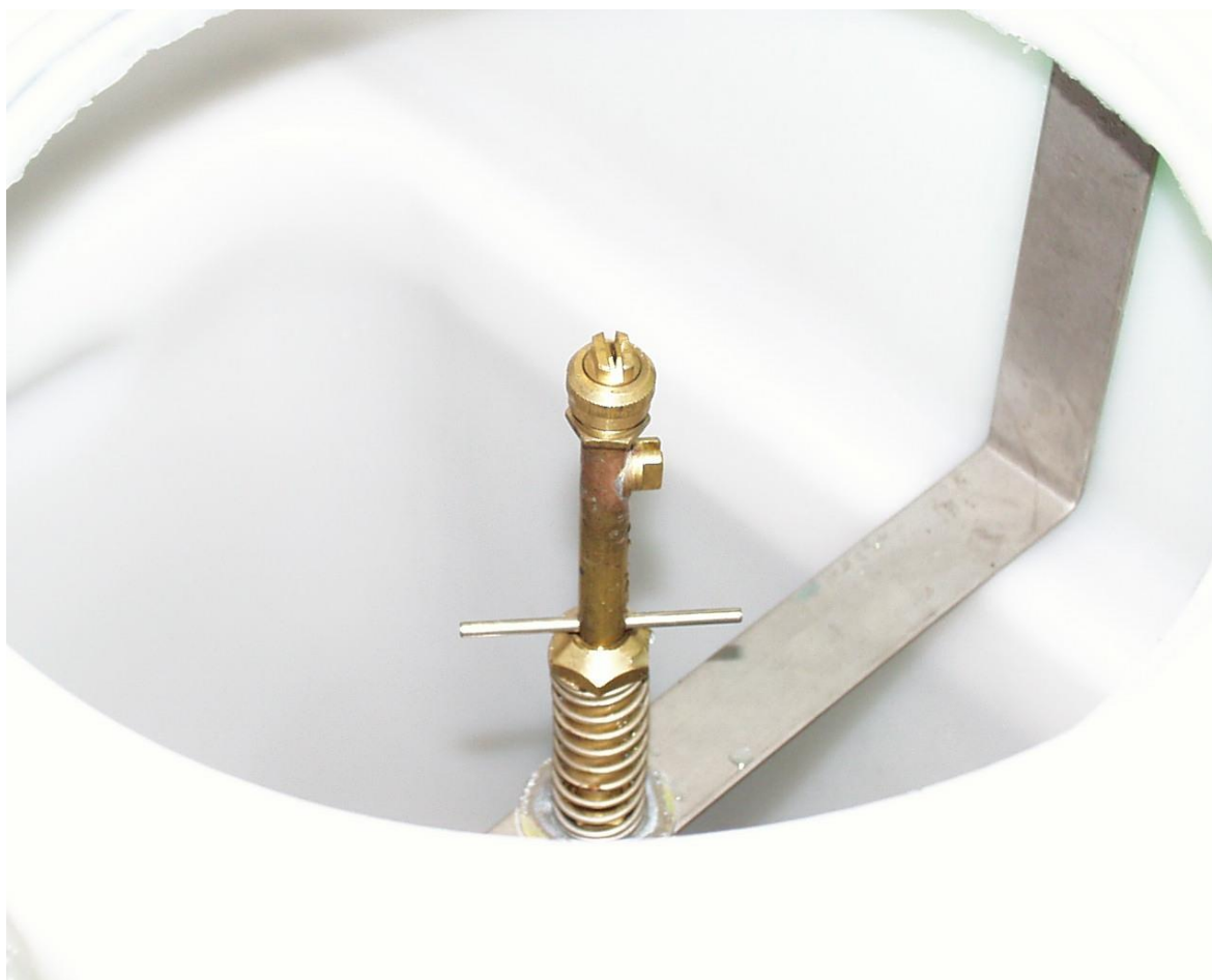
Ugello per il lavaggio dei contenitori ubicato nel serbatoio principale
