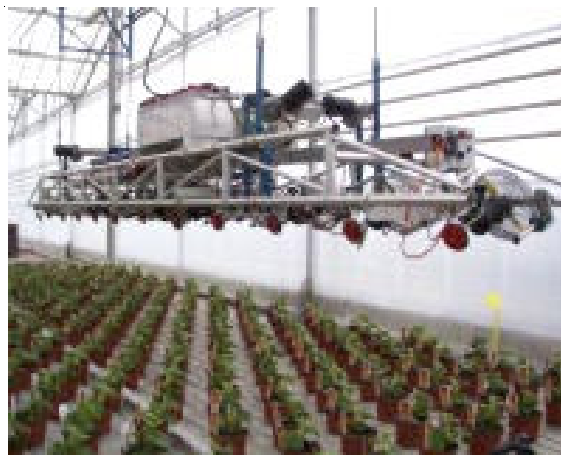
Fig. 33.1 – Robots impiegati per la distribuzione di prodotti fitosanitari in serra: schema a “veicolo” (Guzmán et al., 2004) e a trasferimento sospeso
