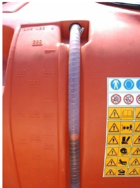
Fig. 4.1 –Particolare dell'indicatore di livello in un serbatoio in polietilene
