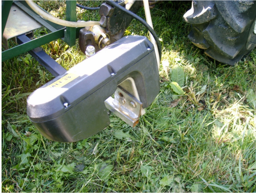
Fig. 9.1 – Sensore di tipo spettrale per il diserbo localizzato nei frutteti
