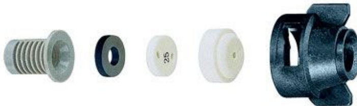
Fig. 10.1 – Parti di un ugello a convogliatore-piastrina. Da sinistra a destra: filtro a fessura, convogliatore, piastrina, ghiera di ancoraggio al raccordo (TeeJet)
