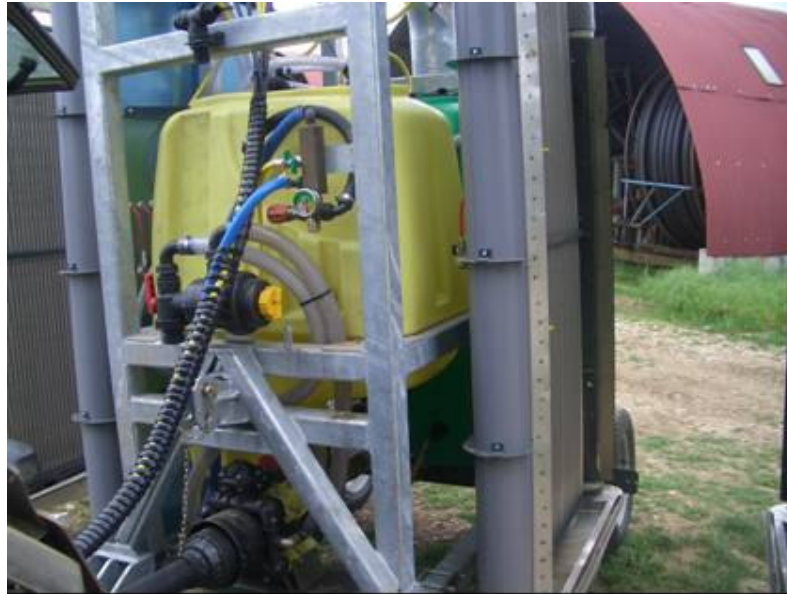
Fig. 2.3 – Il telaio portante con all'interno i due serbatoi in polietilene
