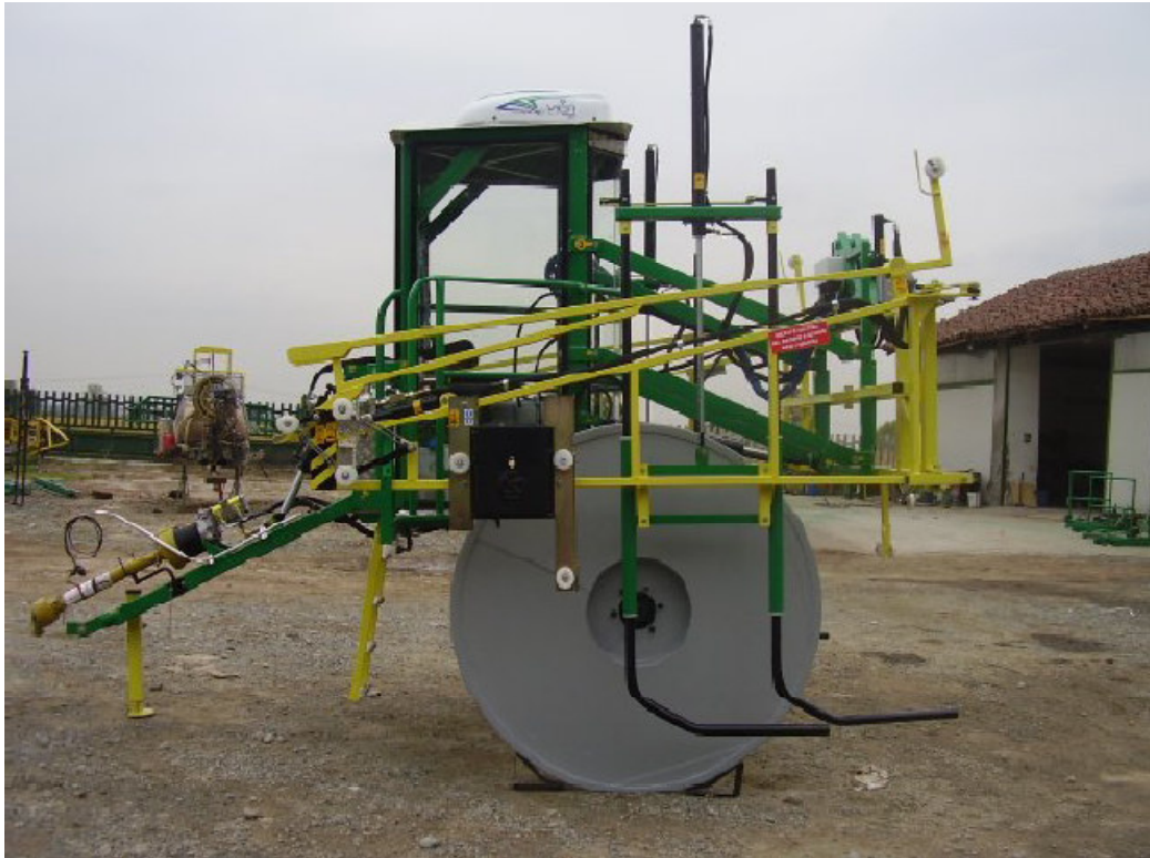
Fig. 3.1 – Umettatrice trainata con ruote in ferro per l'utilizzo in risaia
