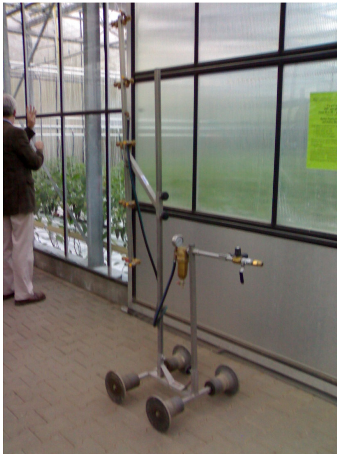
Fig. 32.1 – Trolley allestito per tipologie di serre “all’olandese” in cui le corsie di transito presentano le caratteristiche rotaie
