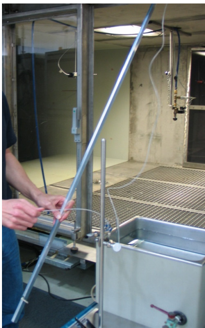
Fig. 8.5 – Estrazione dei depositi di tracciante dai captatori in bagnetto ad ultrasuoni
