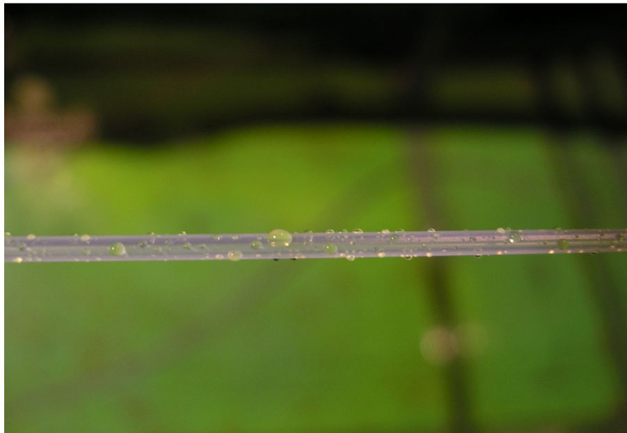
Fig. 5.5 – Line collector su cui sono visibili le goccioline della soluzione fluorescente depositatesi per deriva (BBA)
