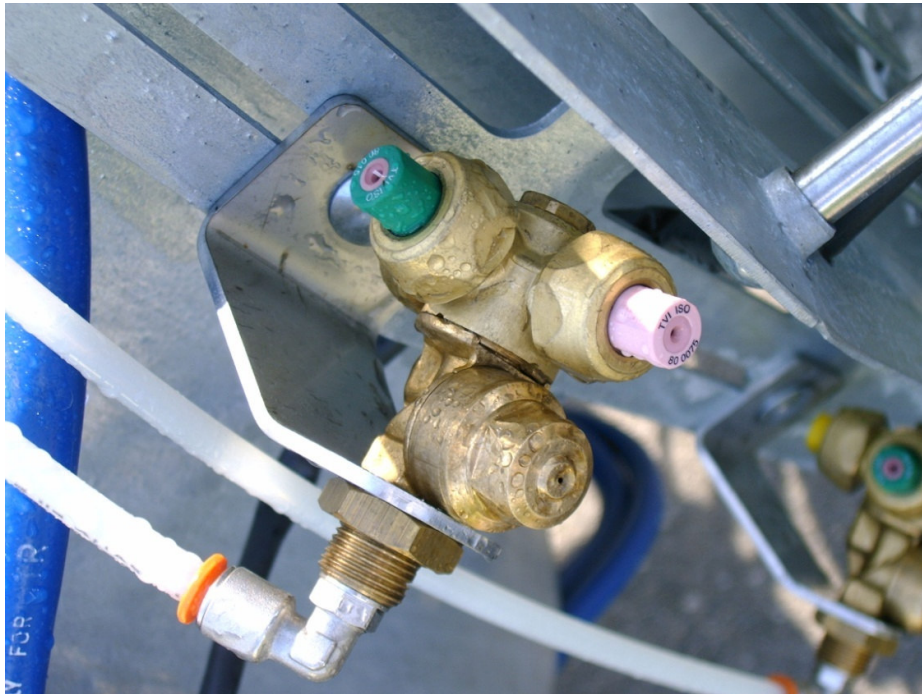
Fig. 18.1 – Gruppo porta ugelli con, a monte, antigoccia a membrana
