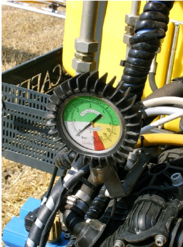
Fig. 8.1 – manometro a scala differenziale
