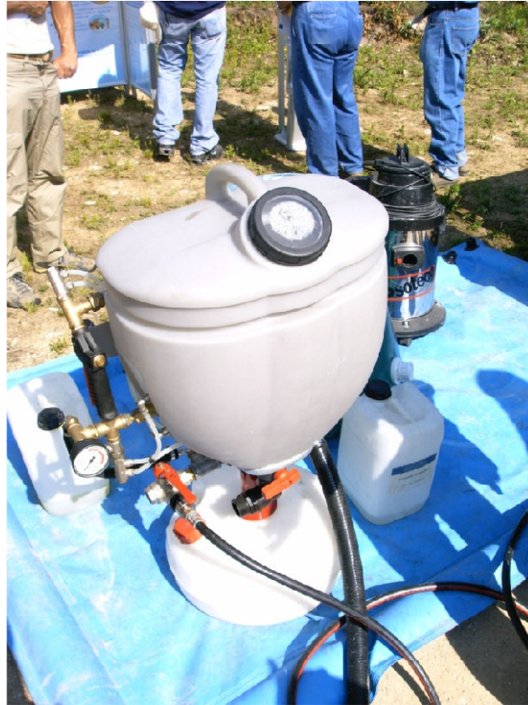
Fig. 2.2 – Dispositivo premiscelatore indipendente
