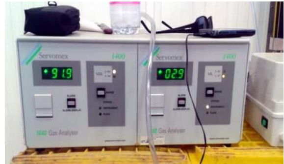
Strumentazione per il controllo della concentrazione di CO 2 all'interno della cella di trattamento.
