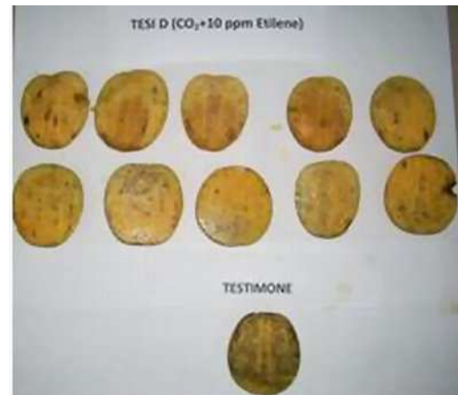
Test veloce per la determinazione visiva del livello di astringenza dei frutti prima (testimone) e dopo il trattamento. Sui frutti, tagliati a metà, vengono distribuite poche gocce di una soluzione di cloruro ferrico. L'intensità della colorazione nera è proporzionale all'astringenza del frutto. Si evidenzia come nel testimone (frutto non trattato) la colorazione scura sia intensa, al contrario di quanto avviene nei frutti trattati (distribuiti nelle due file parallele in foto). 3
